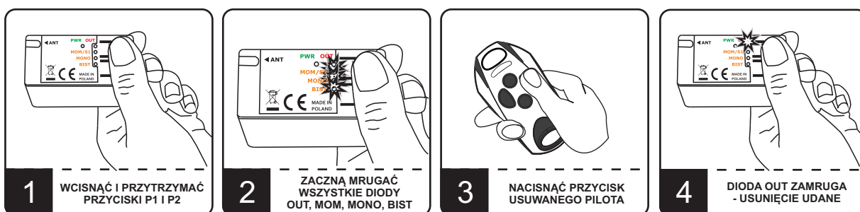
Rys. 4. Usunięcie pilota z odbiornika.
